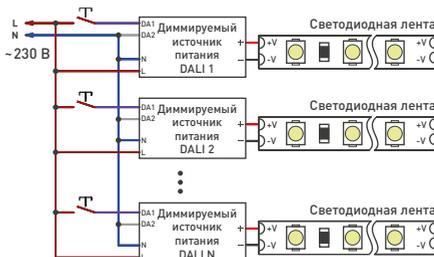
Рис. 4. Схема подключения нескольких источников питания при использовании управления PUSH DIM
