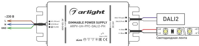
Рис. 1. Подключение источника питания при использовании интерфейса DALI
