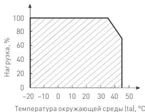
Рис. 2. Максимальная допустимая нагрузка, % от мощности источника
