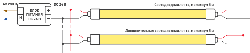
Схема 2. Подключение нескольких светодиодных лент «неон» с двух сторон.
